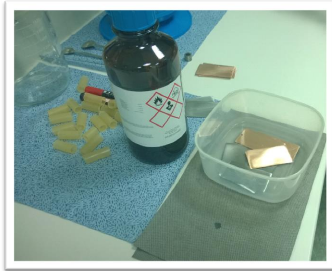
Slika 6.3 Čelični i bakreni paneli u metanolu
