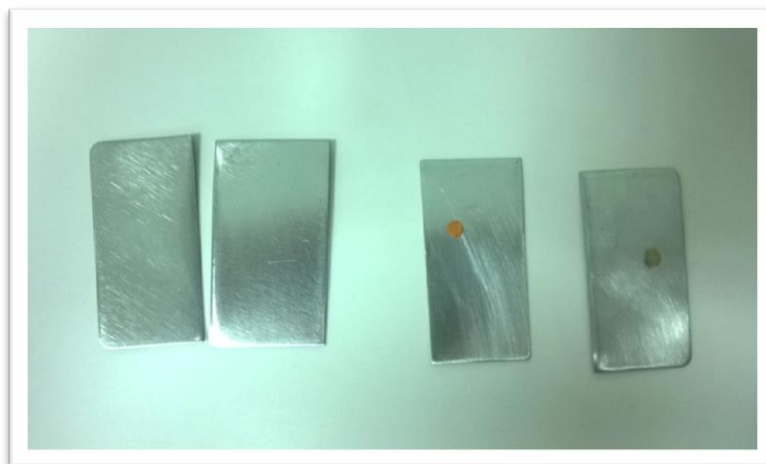
Slika 6.14 Završen test i prikaz korodirane površine
