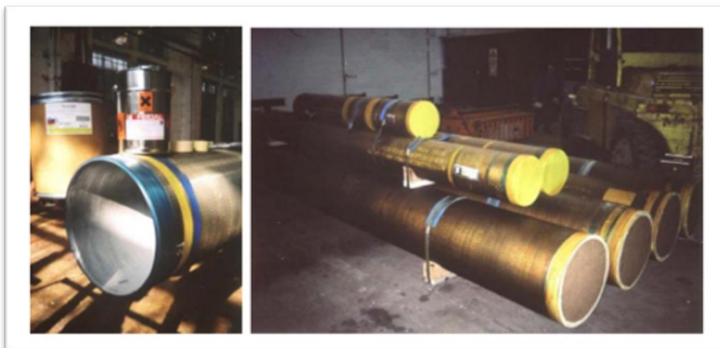
Slika 4.4. Privremena zaštita unutrašnjosti cijevi praškastim inhibitorima korozije [8]
