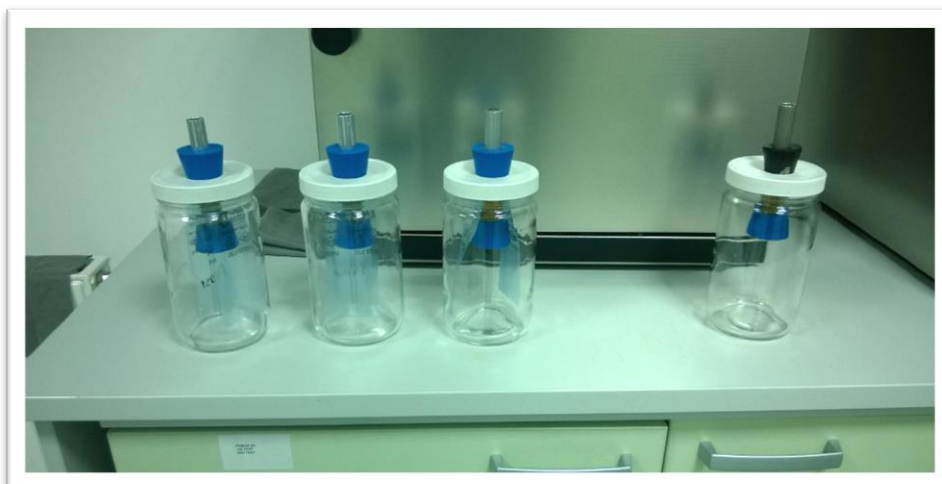
Slika 6.8 Čepovi se nalazi u staklenoj posudi s inhibitorom
